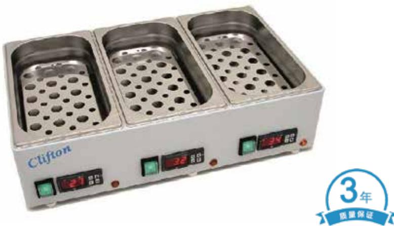
Clifton® TripleBaths™ 系列水浴，采用三槽设计，每个浴槽可独立控温，以满足不同的温度要求，分浅槽型和标准型两个型号，支持多种实验应用。外壳表面采用独特的抗菌技术，可有效抑制细菌生长且易于清洁，一体成型的优质不锈钢内槽，高精度微电脑PID温度控制器和特殊硅橡胶SCS加热技术。加热模块隐藏覆盖于浴槽外部，方便清洁槽内卫生，易于维护，实现槽内空间最大化。特别适合应用于PCR核酸提取、蛋白质纯化、酶活性等实验。
