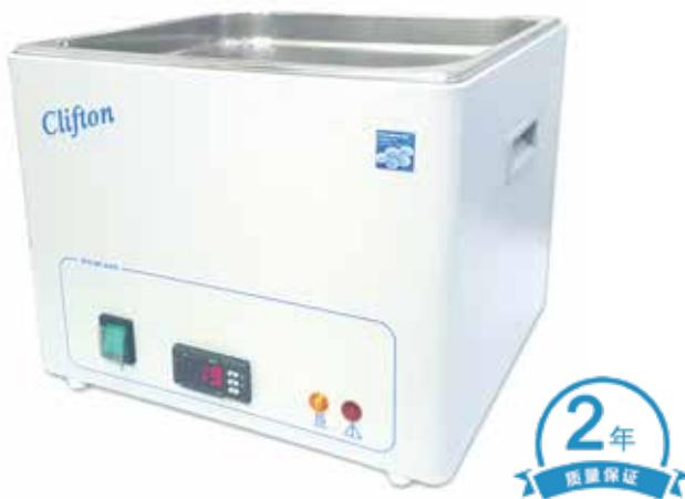
Clifton® NE1BD系列沸腾水浴，专为持续沸腾的应用而设计，能长时间稳定在100°C持续运行，温和加热，不会剧烈地沸腾和产生大量蒸汽。带有恒定液位调节器，无需定期加水，自动保持安全恒定水位，当检测到低水位时，设备停止加热，同时红色警示灯亮起。搁板低高度设计，实现空间利用最大化，与传统水浴相比，较低的水位也可缩短加热时间，节能环保。浴槽容量14L/18L//28L三种可选，外壳表面采用独特的抗菌技术，可有效抑制细菌生长且易于清洁，一体成型的优质不锈钢内槽，高精度微电脑PID温度控制器，广泛的配件可供选择，以满足实验室多种应用需求。
