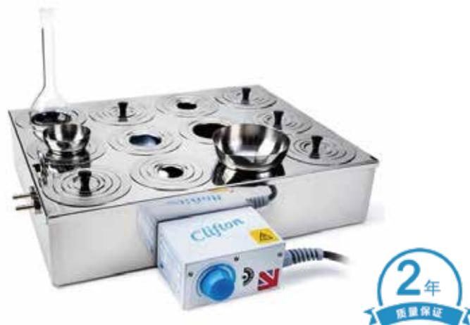
Clifton®1100系列沸腾水浴，多个工作位浴缸设计，能长时间稳定在100°C持续运行，配有多种直径同心圆盖以适配不同大小容器，例如蒸发皿和玻璃器皿，包括圆底烧瓶等，可同时加热放置不同容器。浴槽不锈钢和铝两种材质可选，槽内带护套浸入式加热元件，升温迅速，通过水蒸汽为样品提供有效热源，用于可能会被明火损坏的样品，可控制温和加热，不会产生剧烈沸腾。
